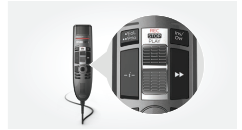
Interrupteur à curseur (enregistrement, arrêt, lecture, retour rapide)
